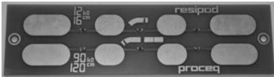
La riga superiore consente il controllo funzionale utilizzando il range 200  $\mu$ A completo. La riga inferiore consente il controllo funzionale utilizzando il campo 50  $\mu$ A ridotto. I resistori dei cuscinetti esterni limitano la corrente massima a circa 20  $\mu$ A (solo due segmenti della striscia sono attivi).
